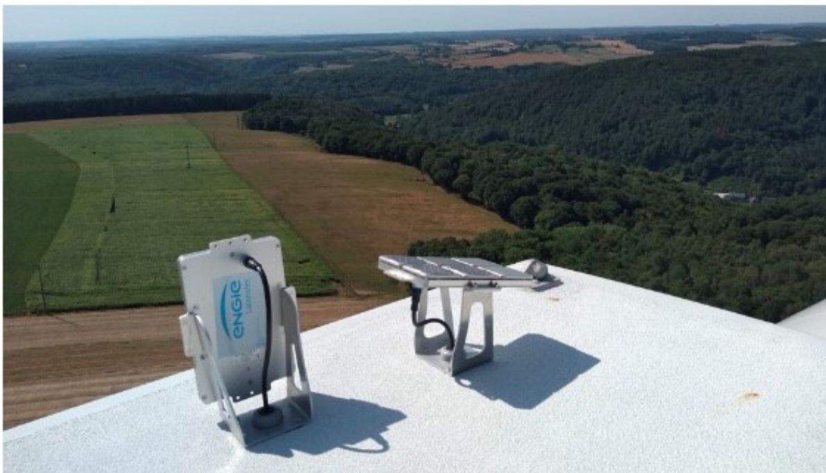
Photo 5 : Illustration d'un système devant éloigner les chauves-souris des éoliennes. Engie Laborelec
