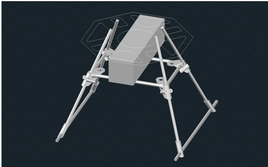
Les 4 premières pièces imprimées servent de support aux suspensions amortisseuses des vibrations. Un autre cadre vient ensuite s'adapter en dessous des suspensions.
