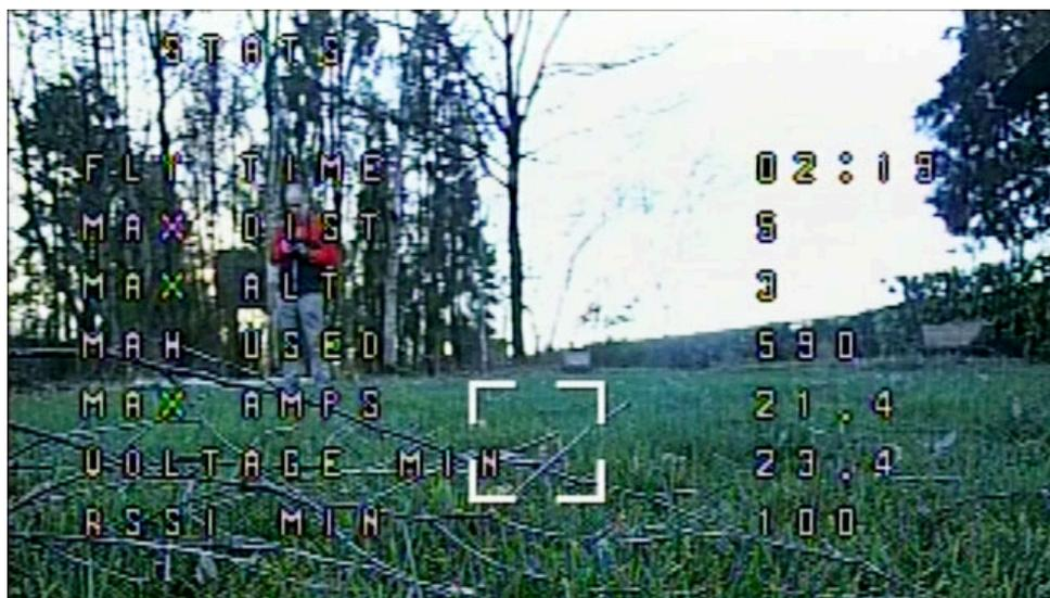
Lors d'un vol en stationnaire de +/- 1'30", la consommation maximale a été de 21,4 Ampères et la consommation de 590 mAh sous 23,4 Volts. La puissance absorbée était donc en moyenne de 500 Watts pour 4,25 Kg, ce qui porte l'efficacité à 8,5 grs/Watt. C'est un peu moins bon que les 420 Watts prévus mais la durée de vol sur 75% des accus sera tout de même de 21 minutes.
